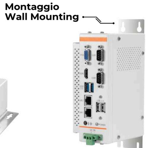
**BOX PC** industriali per montaggio a guida DIN, interno quadro o tavolo. Grazie al loro design e alla loro configurazione estremamente flessibile, si possono avere soluzioni per molteplici tipi di impiego con **CPU con elevate potenze di calcolo**, completamente FANLESS.
