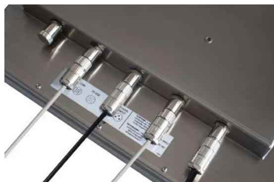
**PC industriali** completamente FANLESS, realizzati in **acciaio INOX AISI 304** con protezione **IP67** totale, per montaggio con attacco **VESA**.
